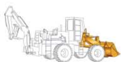
chargeuse F frontale front-end loader cargador M delantero Schauffelader M pala F caricatrice anteriore
